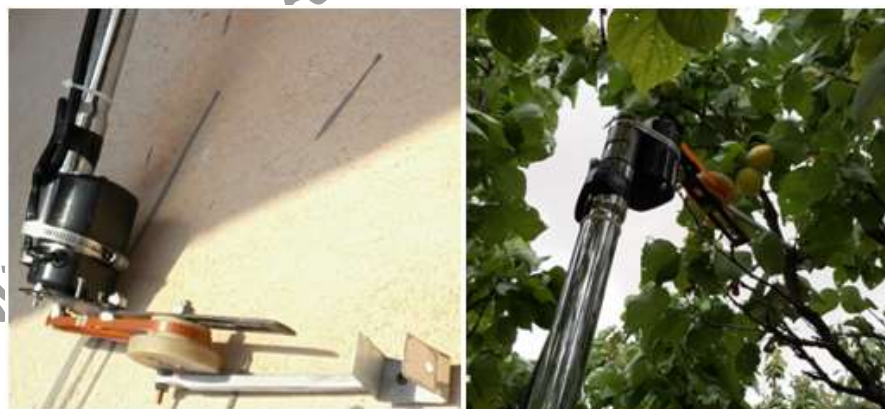
شکل ۲- راست: تصویر شاخه تکان به هنگام برداشت، چپ: مجموعه موتور الکتریکی و پولی چرخ لنگ شاخه تکان زردآلو
