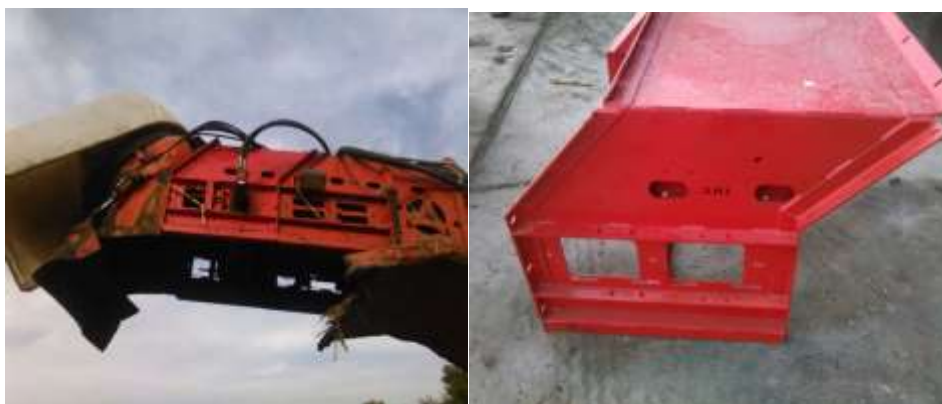
Figure 6. A- Elevator machine after making changes B-Piece added to the device elevator شکل ۶: الف- الواتور دستگاه بعد از انجام تغییرات ب- قطعه اضافه شده به الواتور دستگاه
