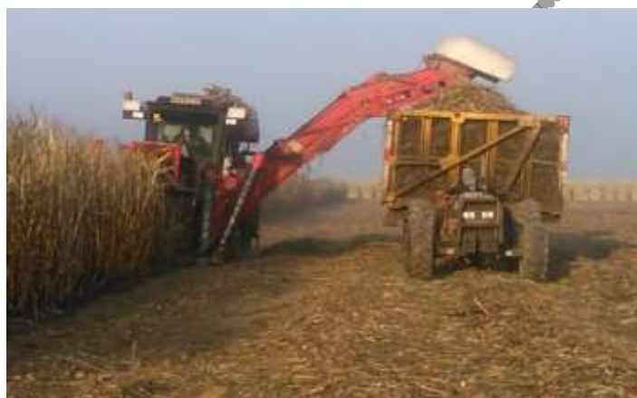
Figure 7. Loading elevator after the change شکل ۷: نحوه بارگیری الواتور بعد از تغییر (دقیقاً نی در وسط سبد ریخته می شود)
