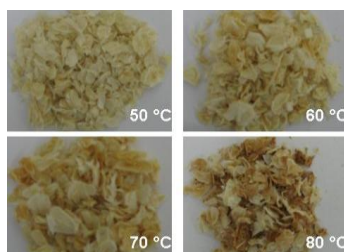
شکل 4- تغییرات رنگ ظاهری ورقه های خشک شده سیر در شرایط بستر سیال
