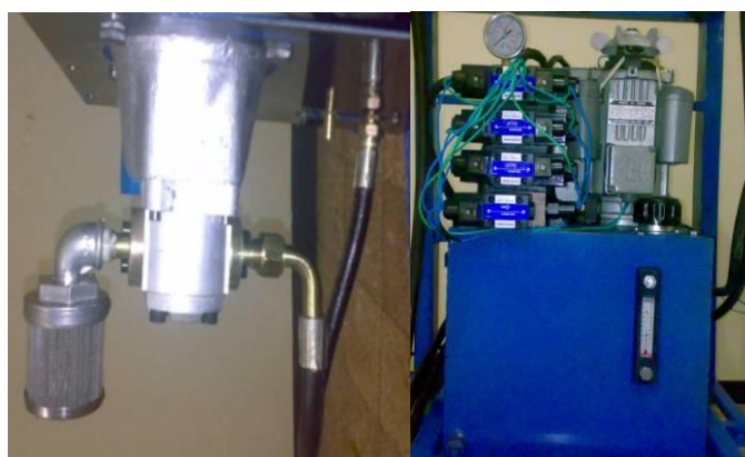
شکل 2- اجزاء سیستم هیدرولیک بیرون از مخزن (راست) و اجزاء سیستم هیدرولیک داخل مخزن (چپ)
