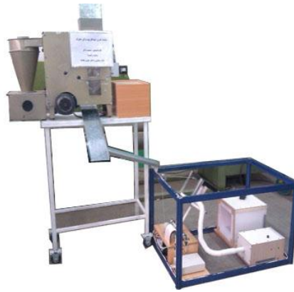
شکل ۱- مجموعه، کامل دستگاه پوست کن و سامانه کنترل خودکار.
