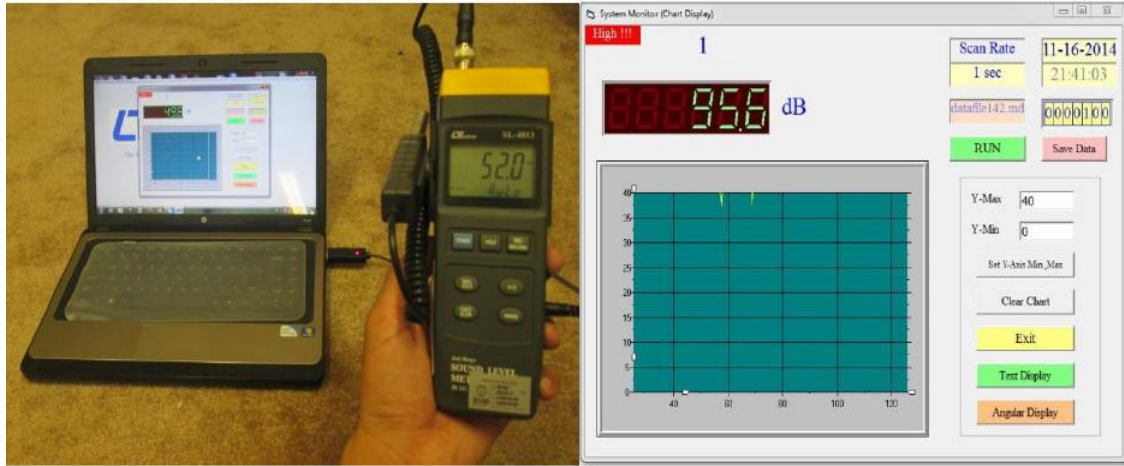
شکل (۱) نحوه انتقال و ذخیره داده، سیگنال‌های صوت به لپ تاپ با استفاده از کابل RS232 و نرم افزار لترون
