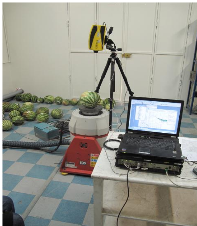
شکل 2. نحوه قرارگیری ارتعاش سنج لیزری
