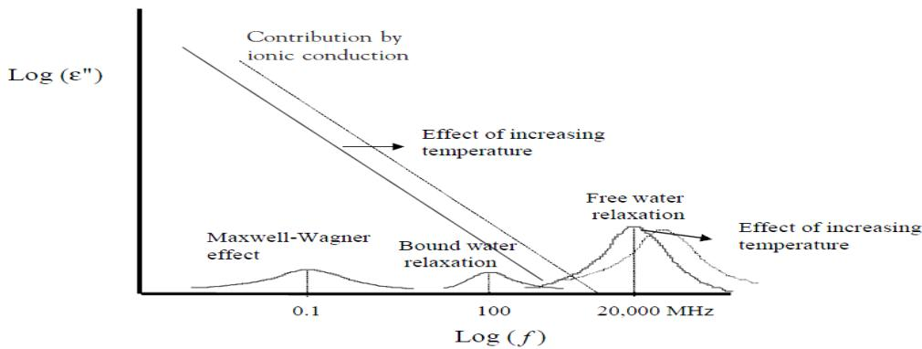
شکل 1: در فرکانس های مایکروویو هر دو عامل پلاریزاسیون یونی و چرخش دو قطبی در تولید حرارت نقش دارند.
