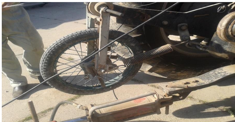
شکل ۳- چرخ پنجم مجهز به حسگر الکترومغناطیسی
