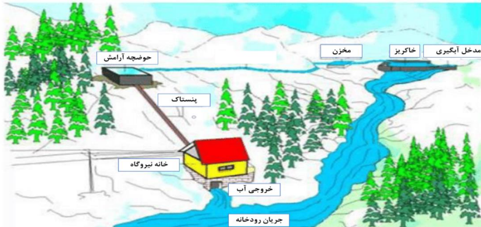
شکل ۲: نیروگاه برق آبی کوچک از نوع جریان رودخانه‌ای
