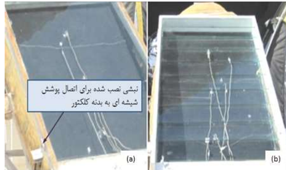
شکل ۳. پوشش شیشه‌ای پله‌ای. a. نوع تخت و b. پله‌ای.
