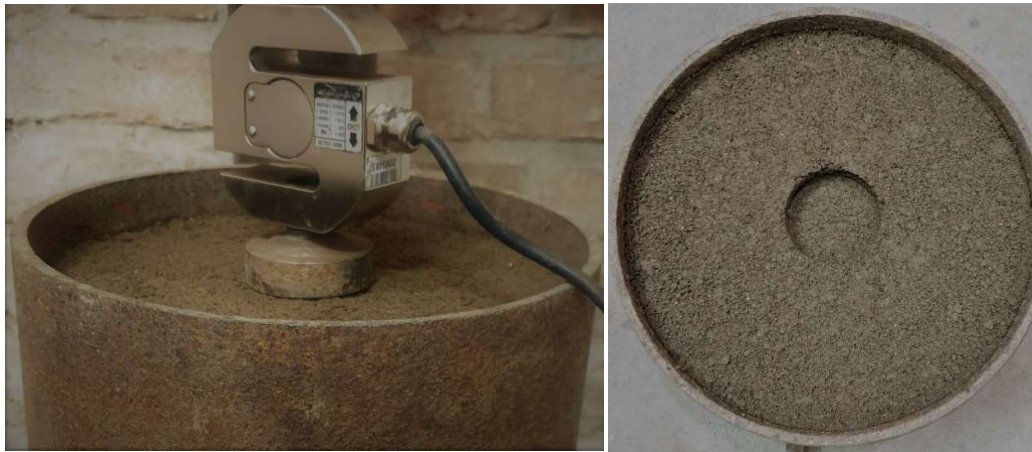
شکل ۱- نمایی از نیروسنج و صفحه بارگذاری طی آزمون نشست صفحه‌ای خاک
