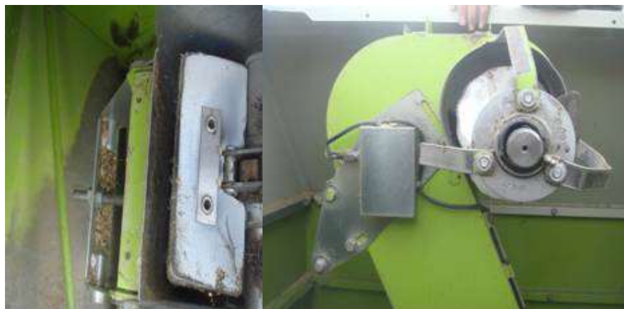
شکل ۱: محل نصب دستگاه اندازه گیر دبی روی الواتور
