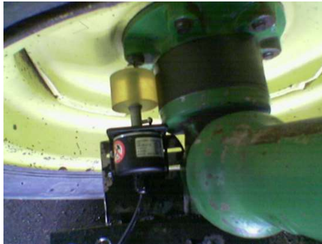
شکل ۴: قرار گیری انکودر بر روی شافت جلو
