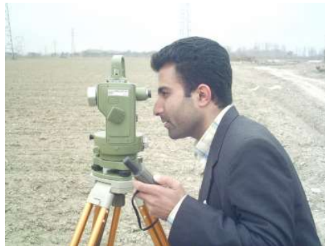
شکل ۲: موقعیت یابی گوشه های مزرعه توسط دوربین نیوو
