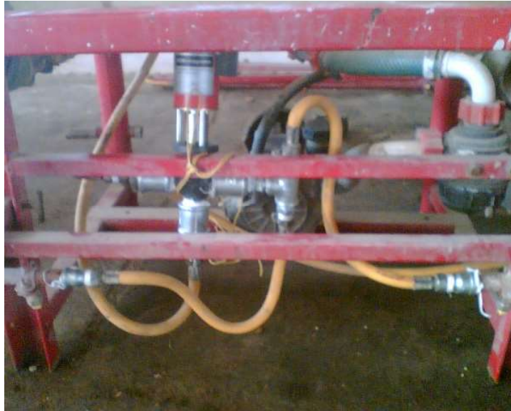
شکل ۶: مکان قرار گیری شیر مغناطیسی بر روی سامانه کودپاش نرخ متغیر این شیر متناسب با مکان مورد نظر روی زمین میزان نرخ پاشش مناسب را اعمال می کند. شکل کلی سیستم به کار برده شده به صورت شکل ۷ است:
