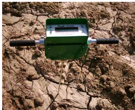
شکل ۲. دستگاه پنترومتر Rimik برای اندازه گیری شاخص مخروطی خاک
