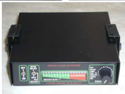
شکل ۱- دستگاه نمایشگر افت دانه و حسگر های مربوطه
