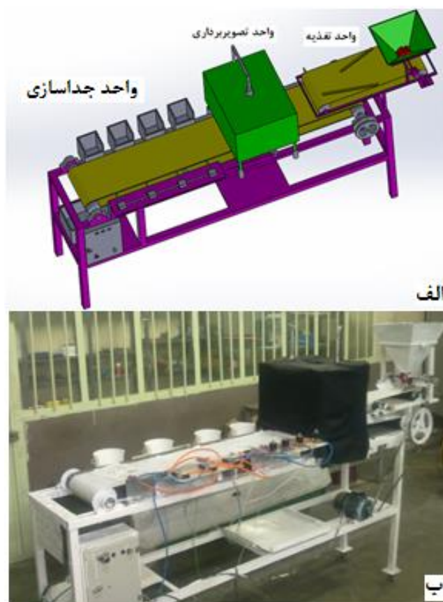
شکل ۲: الف: سامانه طراحی شده ب: سامانه ساخته شده درجه‌بندی انجیر خشک
