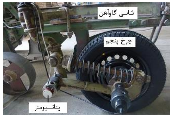
شکل ۲- مکانیزم حسگر عمق کار چرخ پنجم.
