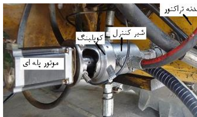
شکل ۶- شیر کنترل و موتور پله ای نصب شده بر روی تراکتور.
