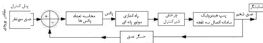
شکل ۷- دیاگرام بلوکی سامانه کنترل الکترو هیدرولیکی.
