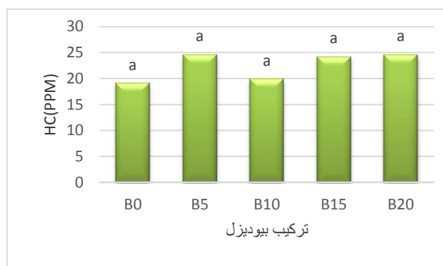
شکل ۵- تاثیر میانگین میزان بیودیزل بر روی آلایندة HC
