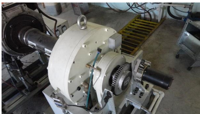
شکل ۲- دستگاه دینامومتر D400 برای اعمال بارهای مختلف
