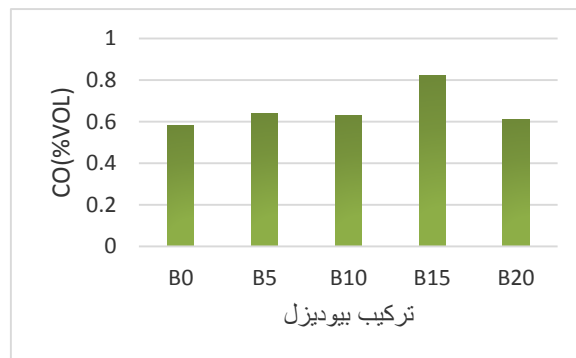
شکل ۱۰- تاثیر افزایش مخلوط سوخت بر روی آلایندہ CO در بار کامل
