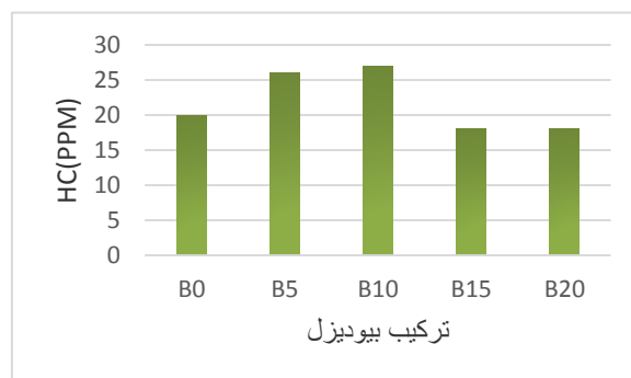
شکل ۱۱- تاثیر افزایش مخلوط سوخت بر روی آلایندہ HC در بدون بار
