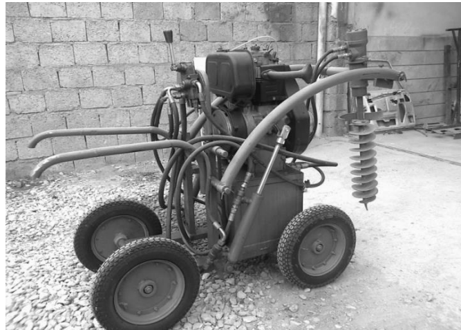
شکل ۱: مکانیسم محرک مته مارپیچ متشکل از موتور و واحد هیدرولیک و بازوهای هادی مته
