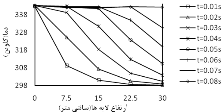
شکل ۴- تقسیم بندی محفظه خشک‌کن توسط iso-surfaces به ۵ صفحه شکل ۵- تغییرات دما نسبت به زمان و موقعیت صفحه در عمق بستر ۹ سانتی‌متر، اندازه مکعب ۴ میلی‌متر و دمای هوای ورودی 70^{\circ}\text{C}
