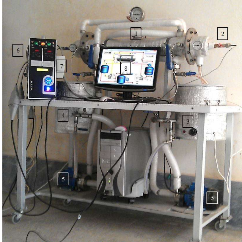
شکل ۳- سامانه حرارتی هوشمند: (۱) مبدل حرارتی پوسته و لوله سازه‌ای، (۲) سنسورهای دمایی، (۳) مخزن مجهز به گرمکن سیال حرارتی، (۴) مخزن سیال سرد، (۵) الکتروپمپ سانتریفوژی استیل، (۶) اینورتر، (۷) کنترلر دیجیتالی و (۸) نرم‌افزار پایش سامانه
