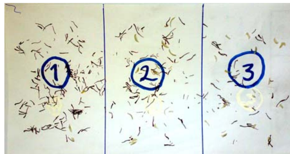
شکل ۳: یک نمونه از وضعیت ریزش مخلوط ناخن و زعفران بر روی کاغذ شاخص مربوط به فاصله ۳۰ سانتی متری و ولتاژ ۱۲ کیلو ولت
