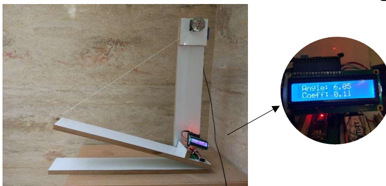
شکل ۱- دستگاه اندازه‌گیری ضریب اصطکاک استاتیکی دانه زیره سبز
