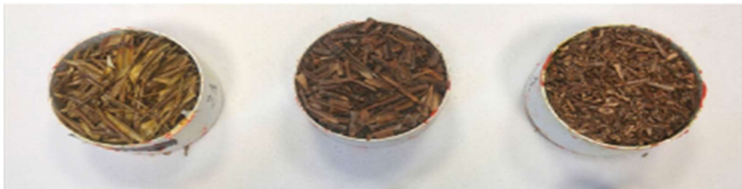
شکل ۷- قرارگیری ضایعات زیتون و چسب کیتوزان در قالب [12]
