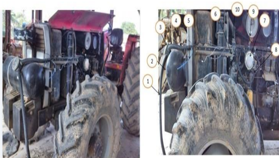
شکل ۱- نحوی قرار گرفتن تجهیزات سیستم سوخت ترکیبی گازوئیل و گاز LPG بر روی تراکتور مسی فرگوسن ۳۹۹
