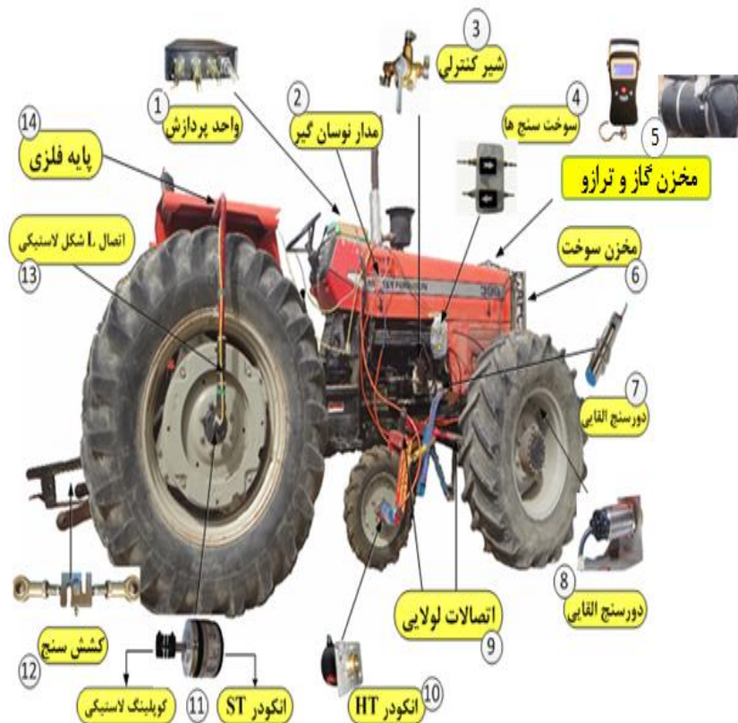
شکل ۵- تراکتور مسی فرگوسن ۳۹۹ مجهز به سیستم سوخت ترکیبی (گازوئیل و گاز مایع نفتی)
