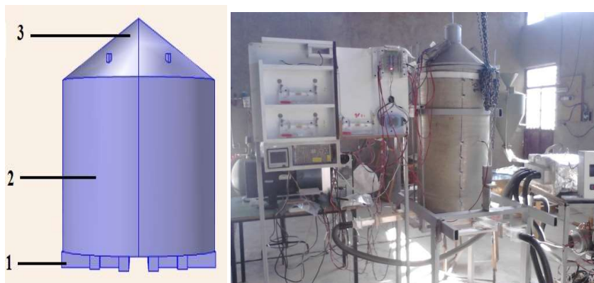
شکل ۳ - مخزن آزمایشگاهی (سمت راست) و ناحیه های مختلف مخزن (سمت چپ)
