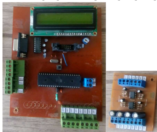
شکل ۵. برد میکرو AVR
