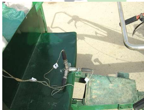
شکل ۲. نحوه قرارگیری و اتصال شتاب‌سنج‌ها در موقعیت صندلی
