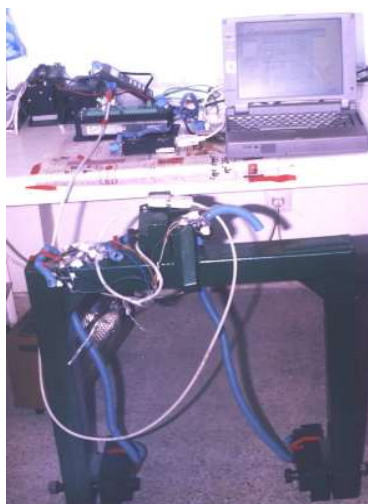
شکل ۱- مجموعه دینامومتر (پایین) و سیستم جمع آوری داده (بالا)
