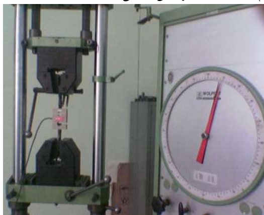
شکل ۵- کالیبراسیون لودسل با استفاده از دستگاه آزمون کشش
