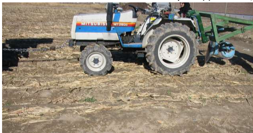
شکل ۷- آزمون مزرعه ای دینامومتر اتصال سه نقطه
