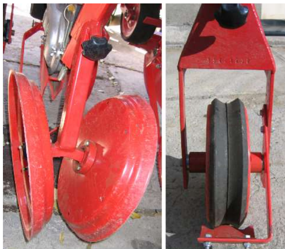
شکل ۲- تصویر سمت راست چرخ فشار مخصوص بذر ریز و تصویر سمت چپ چرخ فشار مایل ماشین ردیف کار.
