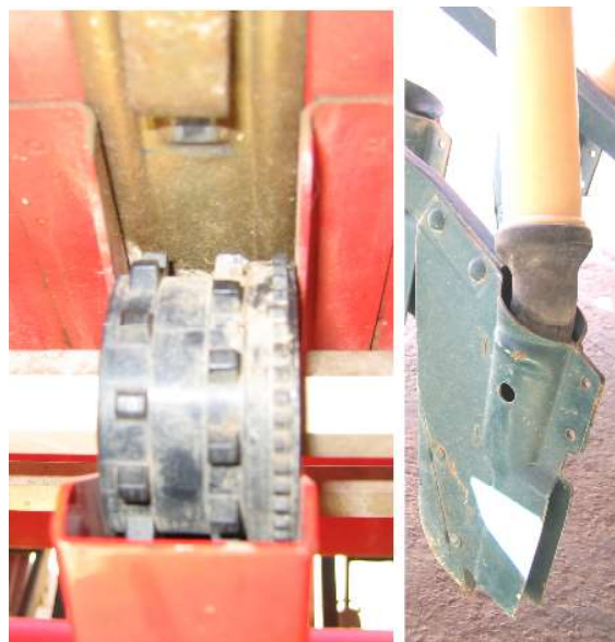
شکل ۱ - تصویر سمت راست شیار بازکن نوع کفشکی و تصویر سمت چپ موزع حجمی استوانه ای دندانه دار در ماشین خطی کار.
