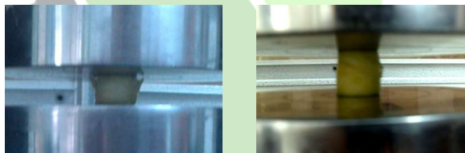
شکل ۷: گسیختگی ترد (سمت راست)، گسیختگی فشاری (سمت چپ)
