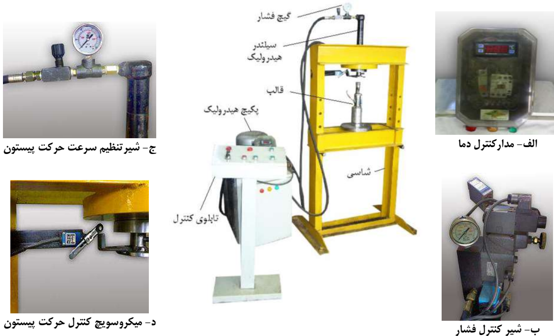
شکل ۱ - دستگاه پرس هیدرولیکی و قسمتهای مختلف آن
