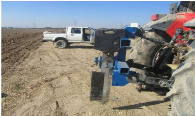
شکل ۱. نفوذسنج افقی مرکب (Naderi-Boldaji et al. , 2012)
