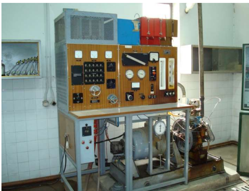
شکل (۳). دینامومتر الکتریکی ساخت شرکت Tecquipment
