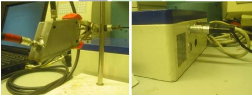
شکل ۱. دستگاه طیف سنج مورد استفاده برای تعیین کربن خاک مدل corona ۴۵ (شرکت زایس)
