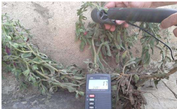
شکل ۴- نحوه اندازه‌گیری سرعت باد مورد نیاز برای جدا کردن گل از بوته با استفاده از بادسنج از نوع سیم داغ
