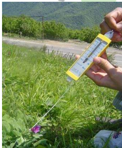
شکل ۵- نحوه اندازه‌گیری میزان نیروی کششی مورد نیاز برای جدا کردن گل از ساقه
