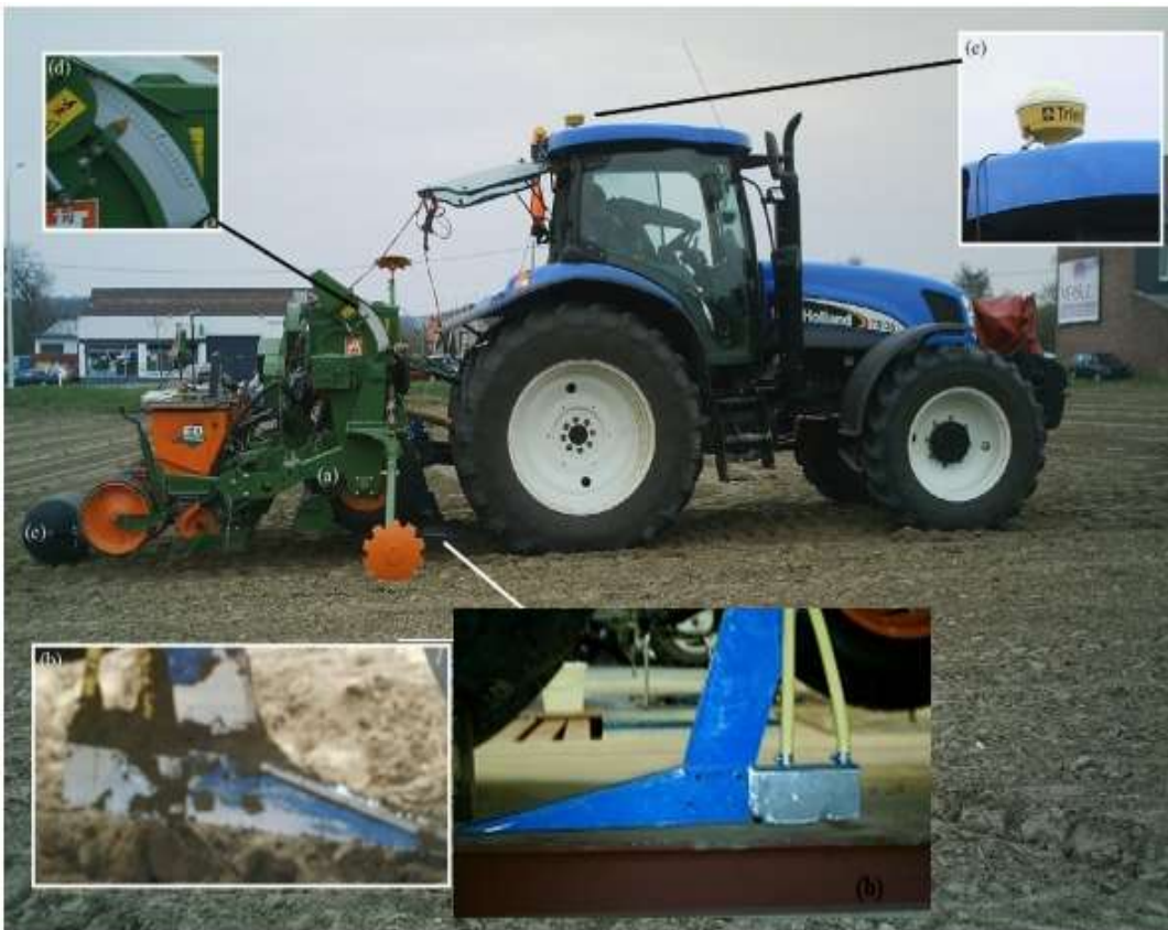
شکل ۲. حسگر نرخ متغیر pH خاک مورد استفاده در مطالعه، (b) حسگر خاک و ساب‌سویلر.
