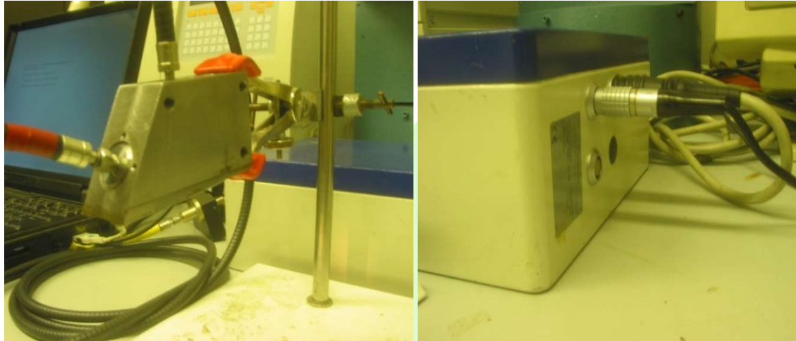
شکل ۱. دستگاه طیف‌سنج مورد استفاده برای تعیین pH خاک، مدل zeiss corona 45
