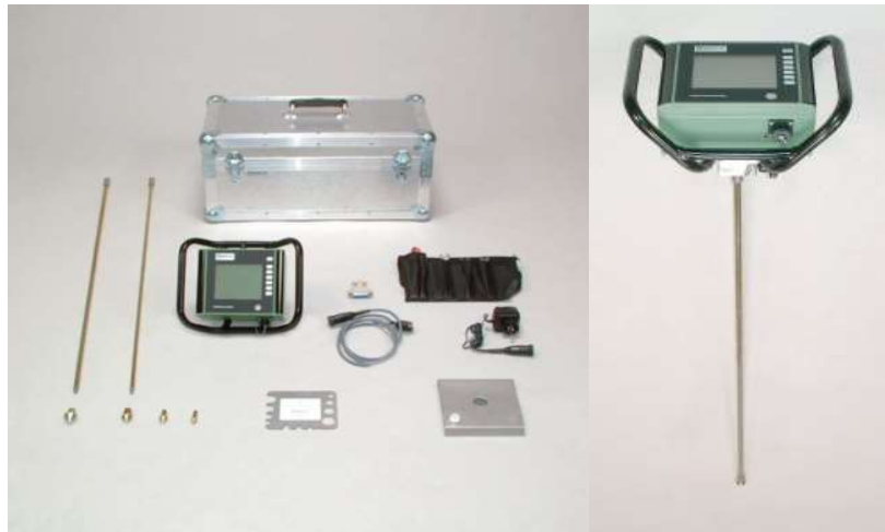
شکل ۱. دستگاه پنترولاگر برای اندازه گیری مقاومت به نفوذ خاک
