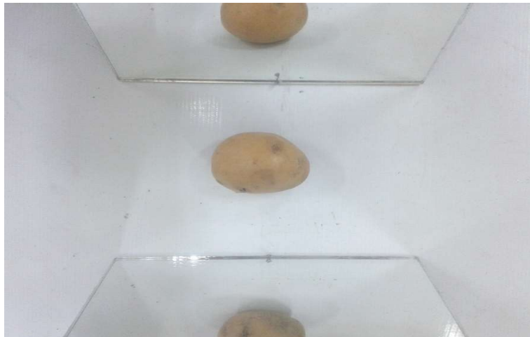
شکل ۵: تصویری گرفته شده توسط نرم افزار از سیب زمینی در حال عبور از محفظه نور
