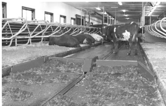
شکل ۳: مکانیزم جمع آوری کود به روش تیغه تمیزکننده متحرک [۱۰]
