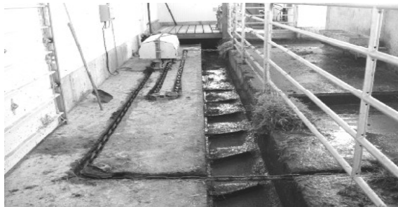
شکل ۲: کانال، موتور الکتریکی، پره های کف کانال و زنجیرهای رابط درحین کار [۱۸]
