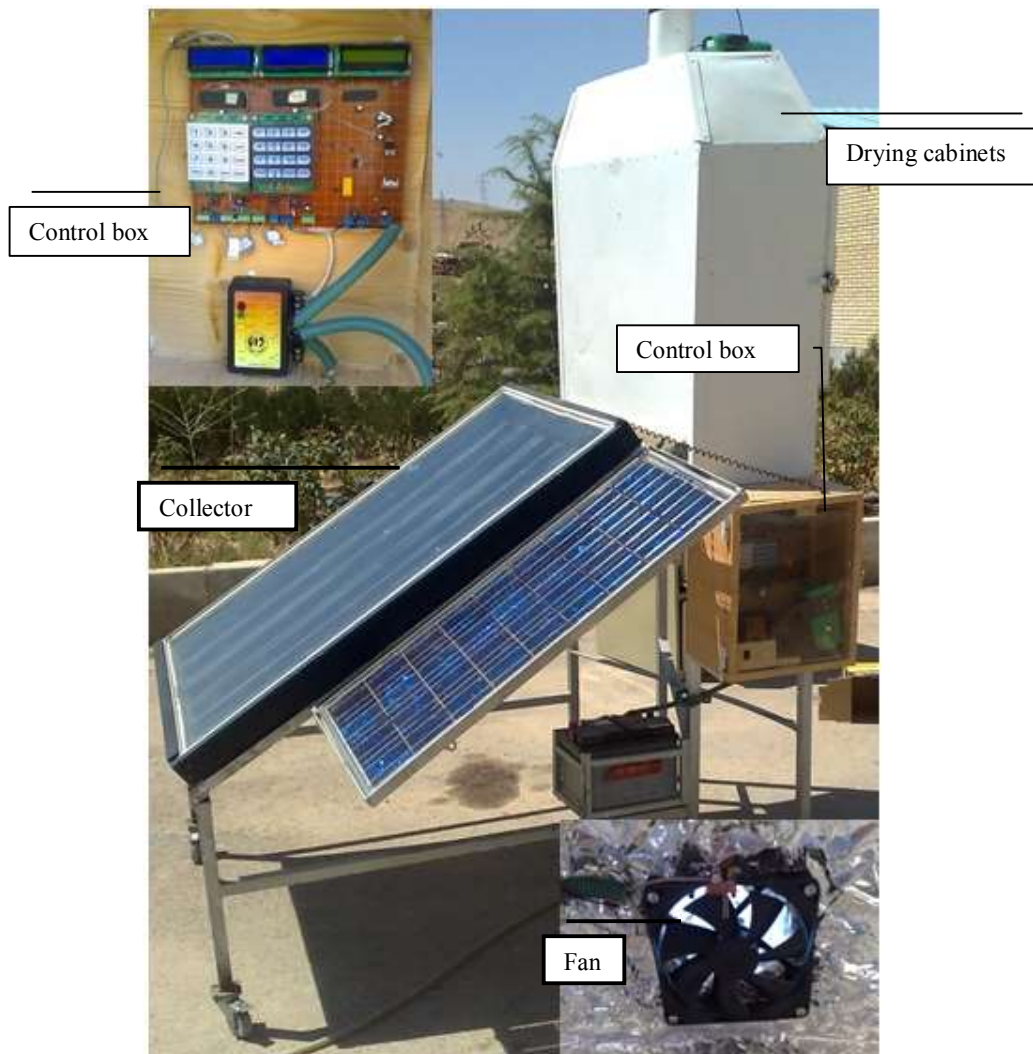
شکل ۲. خشک کن مجهز به سامانه کنترل دور فن
