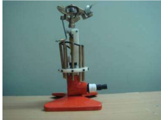
شکل ۷- آب پاش زراعی مکانیکی با مکانیزم ضربه‌ای برای آبیاری سطوح چند ضلعی ساخته شده
