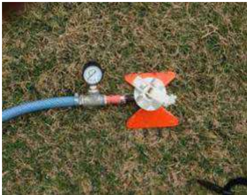
شکل ۲- آب‌پاش زراعی مکانیکی با قابلیت آبیاری سطوح مربعی [۱]
