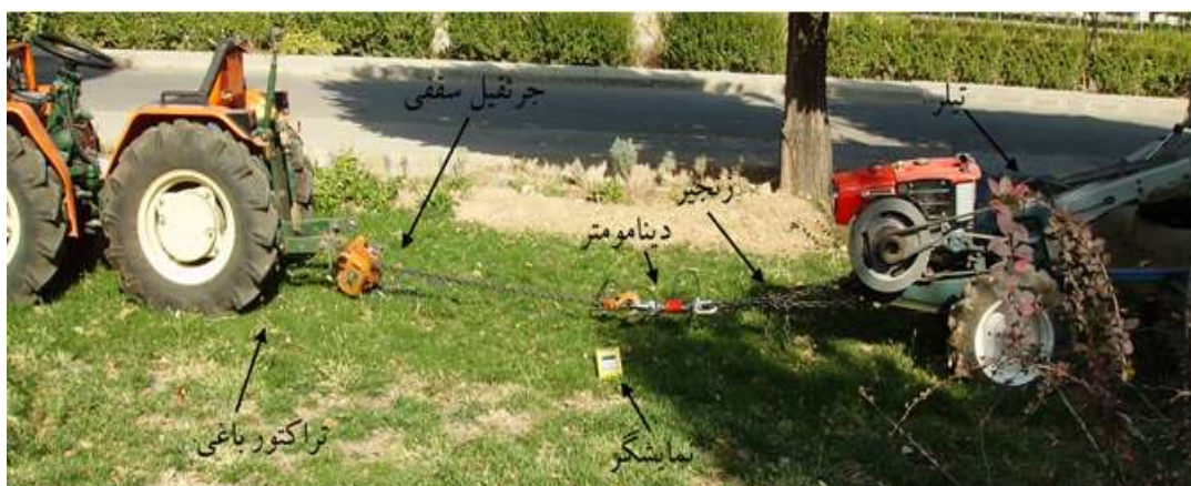
شکل ۵- نحوه اتصال دینامومتر برای ازه گیری مقاومت کششی حین ارزیابی دستگاه
