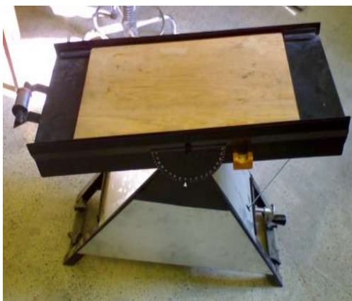
شکل ۱: دستگاه تعیین زاویه اصطکاک استاتیکی
