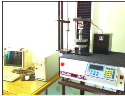
شکل ۲- دستگاه مورد استفاده برای تعیین نیروی گسیختگی، اینسترون (مدل Santam SMT-5)
