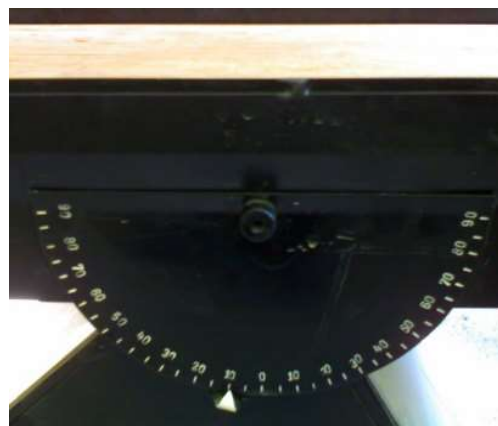
شکل ۱: دستگاه تعیین زاویه اصطکاک استاتیکی
