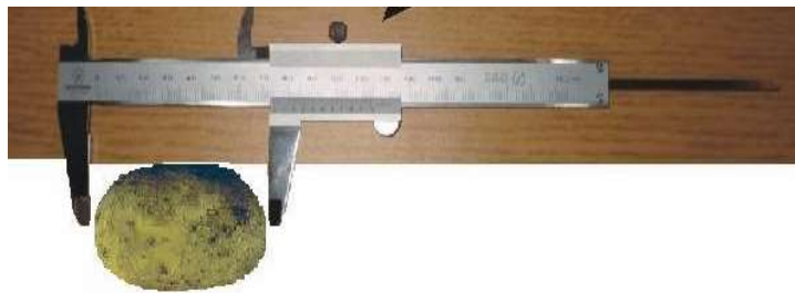
شکل ۱- اندازه گیری ابعاد سیب زمینی توسط کولیس
