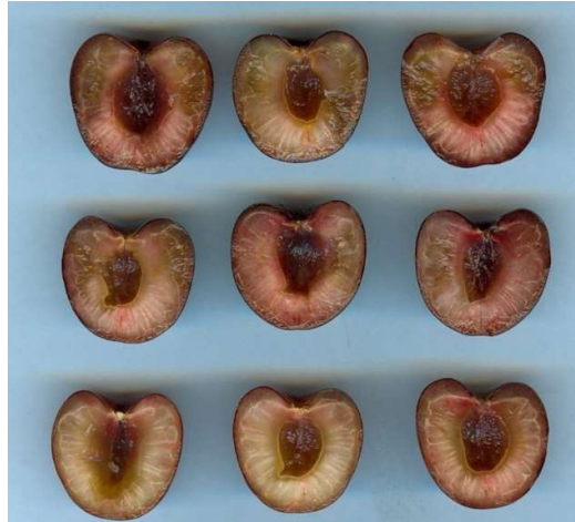
شکل ۳- لهیدگی داخلی گیلان در اثر بارگذاری فشاری استاتیکی به ترتیب از بالا ۱۰، ۸، و ۶ نیوتن
