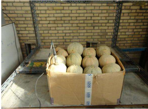
شکل ۲- نحوه اندازه‌گیری ارتعاشات در سطح میوه و دستگاه‌های مورد استفاده در آزمایش
