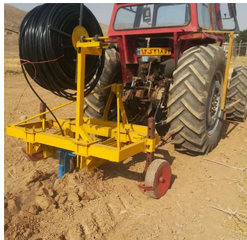
شکل ۲- نمایی از دستگاه لوله گذار آبیاری زیر سطحی متصل شده به تراکتور.
