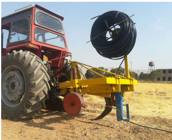
شکل ۲- نمایی از دستگاه لوله گذار آبیاری زیر سطحی متصل شده به تراکتور.
