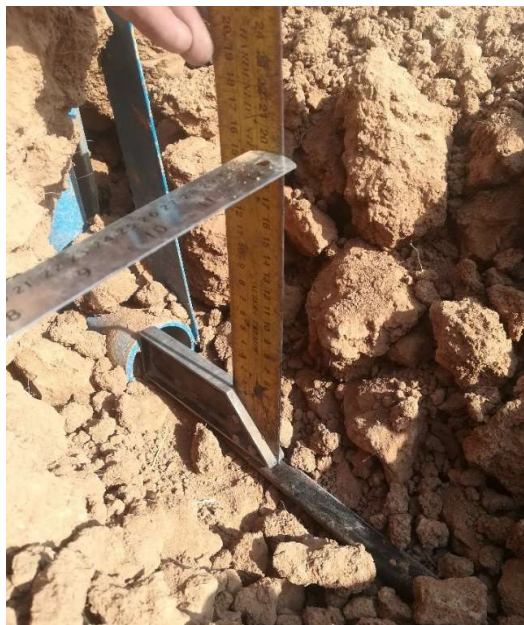
شکل ۳- نمایی از عمق کارگذاری اندازه گیری شده توسط لوله گذار آبیاری زیرسطحی.
