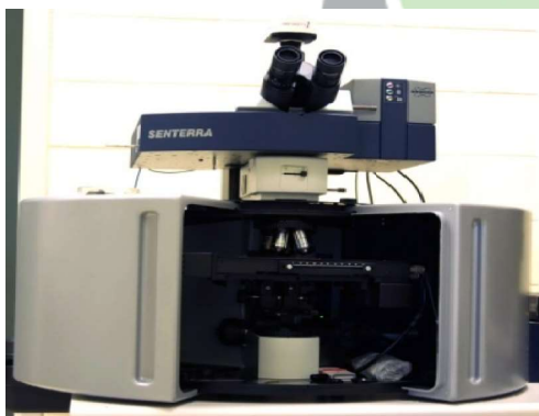
شکل ۱- سامانه طیف‌سنج رامان مورد استفاده
